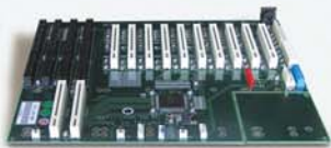
Объединительные платы фирм Advantech, Portwell, iEi Technology
