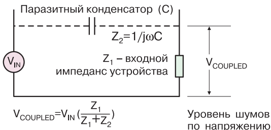
Рис. 8. Эквивалентная схема источников шумов, проникающих в устройство через паразитный конденсатор
