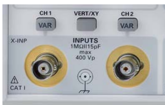
Рис. 1. Расположение органов управления и входов Yt и XY
