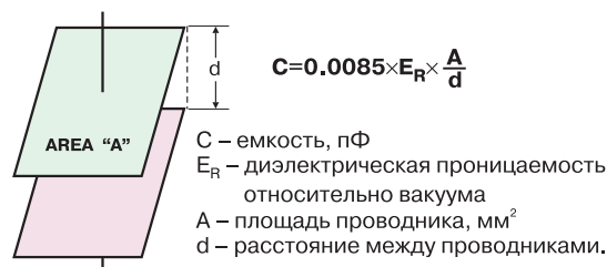
Рис. 6. Модель паразитного конденсатора
